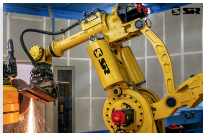
Grinding operation on a steel components. // Schleifarbeiten an Stahlelementen.
