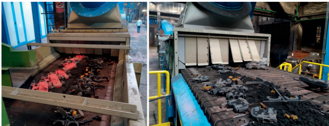
Castings and sprues before and after the MCC® cooling tunnel. // Gusstücke und Angüsse vor und nach dem MCC®-Kühltunnel.
