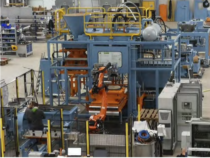
Core Machine produced for Eku Fren Kampana ve Döküm Sanayi A.Ş Turkey EKU Fren Kampana Ve Dokum Sanayi AS için üretilmiş olan maça makinesi
